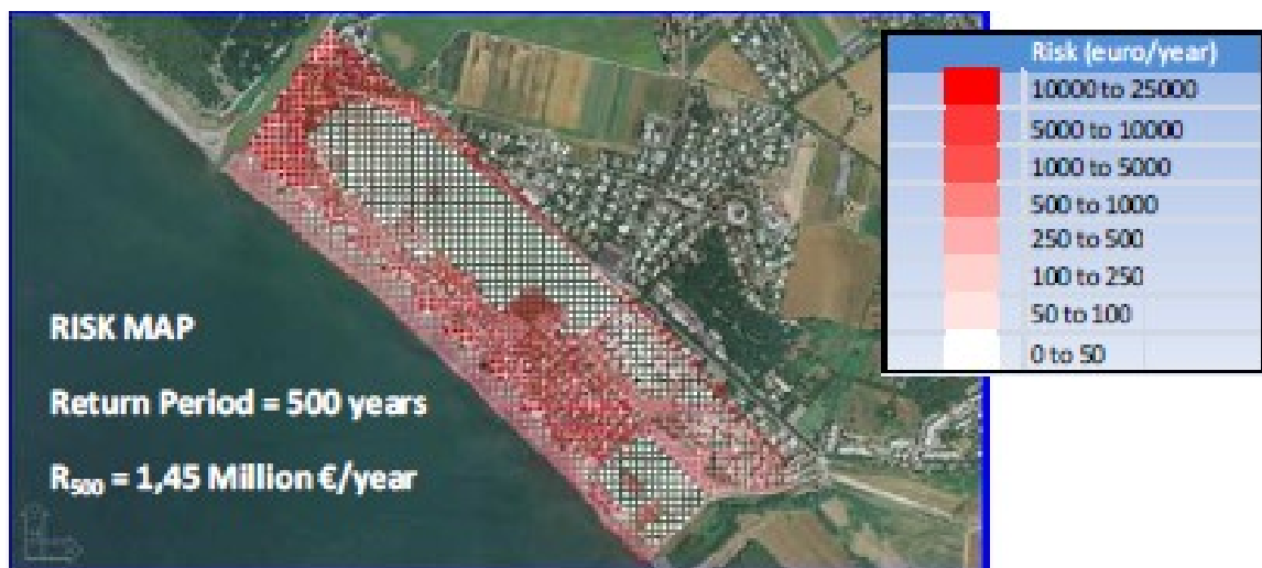
Εικόνα 2: Παράδειγμα χαρτών κινδύνου πλημμύρας για μία συγκεκριμένη καταγίγδα. Ο κίνδυνος πλημμύρας έχει υπολογιστεί σε ευρώ ανά έτος. Για την πιλοτική περιοχή Montalto di Castro (Ιταλία)
